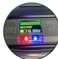
赤/青LED付きOLEDフルカラーディスプレイでポンプ状態を表示し離れていても視認可能
